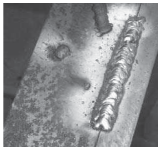
Detalle de costura con electrodo.
